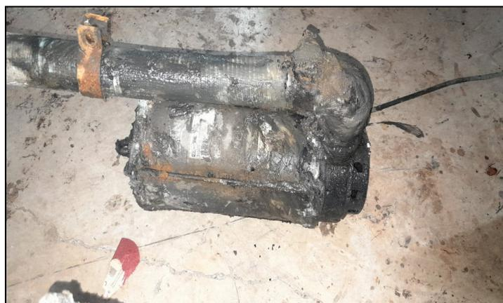
2.1.5. Consta-se pelas imagens que a bomba precisa ser substituída por outra uma vez que já se encontra inadequada para o seu regular funcionamento.
