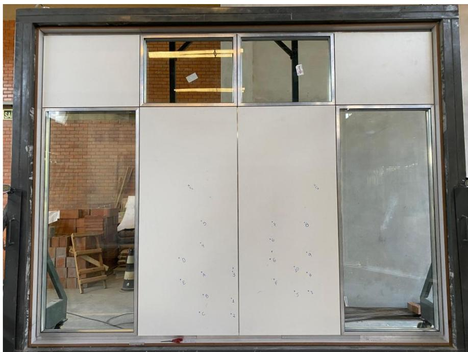
**Figura A.1 – Execução de impacto de corpo duro**
