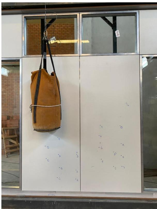
**Figura A.2 – Execução de impacto de corpo mole no ponto A**
