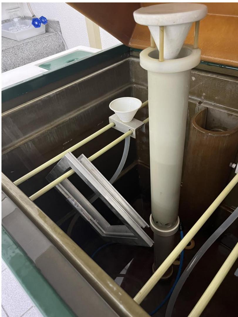
**Figura 1 –** Posicionamento das amostras no interior da câmara.
