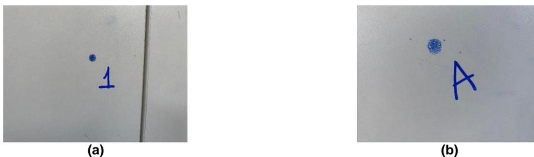
**Figura 2 – Condição superficial da amostra após impacto de corpo duro com energia de: (a) 2,5 J, e (b) 5,0 J**
