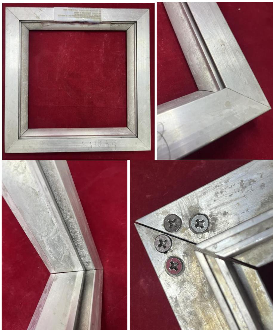
**Figura 5** - Registro fotográfico final, após 72 horas de exposição, mostrando a amostra sem indícios de pontos de corrosão vermelha.
