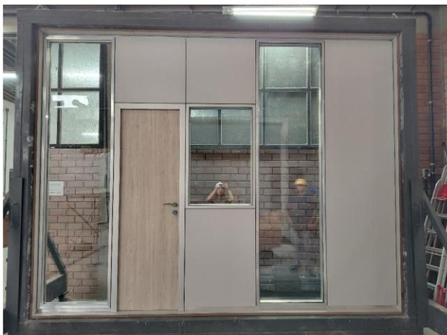
Figura A.2 – Montagem do sistema rotacionado horizontalmente em 180°
