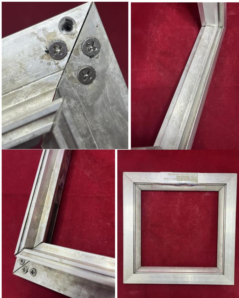
**Figura 3** - Registro fotográfico após 48 horas de exposição, mostrando a amostra sem indícios de pontos de corrosão vermelha.
