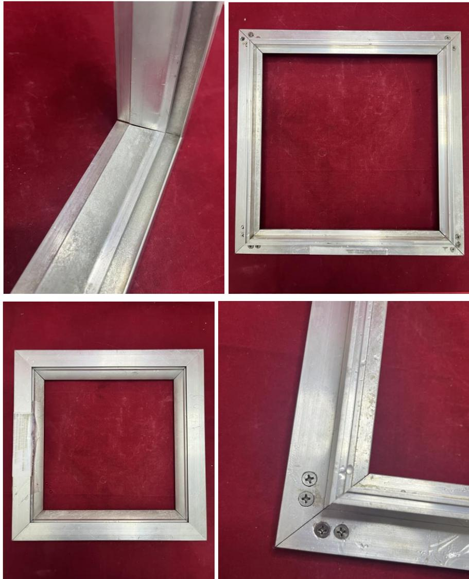
**Figura 2** – Registro fotográfico após 24 horas de exposição, mostrando a amostra sem indícios de pontos de corrosão vermelha.
