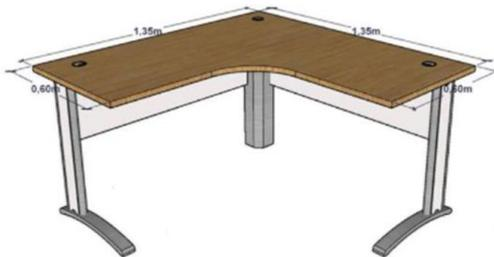
1. Tampo em “L” em MDF ou MDP, com 25mm de espessura, medindo 1350x1350mm (LxP), com duas saídas laterais de 600mm, revestido em ambas as faces por laminado melamínico **referência LOURO FREIJÓ ARAUCO, para manter padronização do STM**. O bordo que acompanha todo o contorno do tampo é encabeçado com fita de poliestireno de
