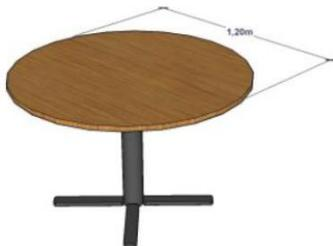
1. Tampo inteiriço, em formato circular, confeccionado em MDF ou MDP, com 25mm de espessura, medindo 1200mm de diâmetro, revestido em ambas as faces por laminado melamínico referência LOURO FREIJÓ ARAUCO, para manter padronização do STM. O bordo que acompanha todo o contorno do tampo é encabeçado com fita de poliestireno de 2,5mm de espessura, coladas com adesivo hot melt, com arestas arredondadas e raio ergonômico de 2,5mm. A
