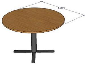
1. Tampo inteiriço, em formato circular, confeccionado em MDF ou MDP, com 25mm de espessura, medindo 1000mm de diâmetro, revestido em ambas as faces por laminado melamínico referência LOURO FREIJÓ ARAUCO, para manter padronização do STM. O bordo que acompanha todo o contorno do tampo é encabeçado com fita de poliestireno de 2,5mm de espessura, coladas com adesivo hot melt, com arestas arredondadas e raio ergonômico de 2,5mm. A
